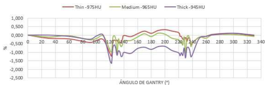
Figure 241: Diferencia porcentual angular entre la intensidad medida y calculada sobre la estructura Halcyon Couch, caracterizada por -970 HU y -300HU para su superficie interna y externa, respectivamente.
