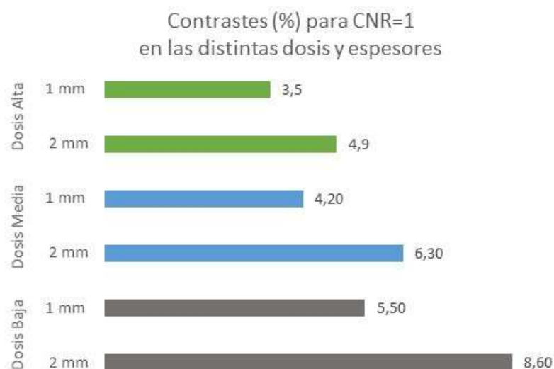
Figure 477: Contraste para CNR=1 y distintas dosis y espesores
