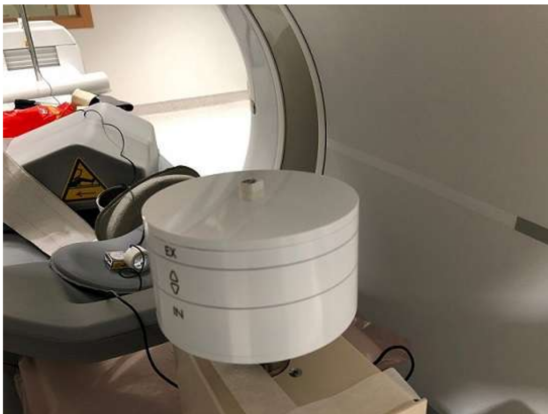
Figure 491: Disposición del maniquí. La fuente es colocada sobre la cabeza de manera que se desplaza verticalmente y se alinea con los láseres para que esté en el centro horizontal del FOV.
