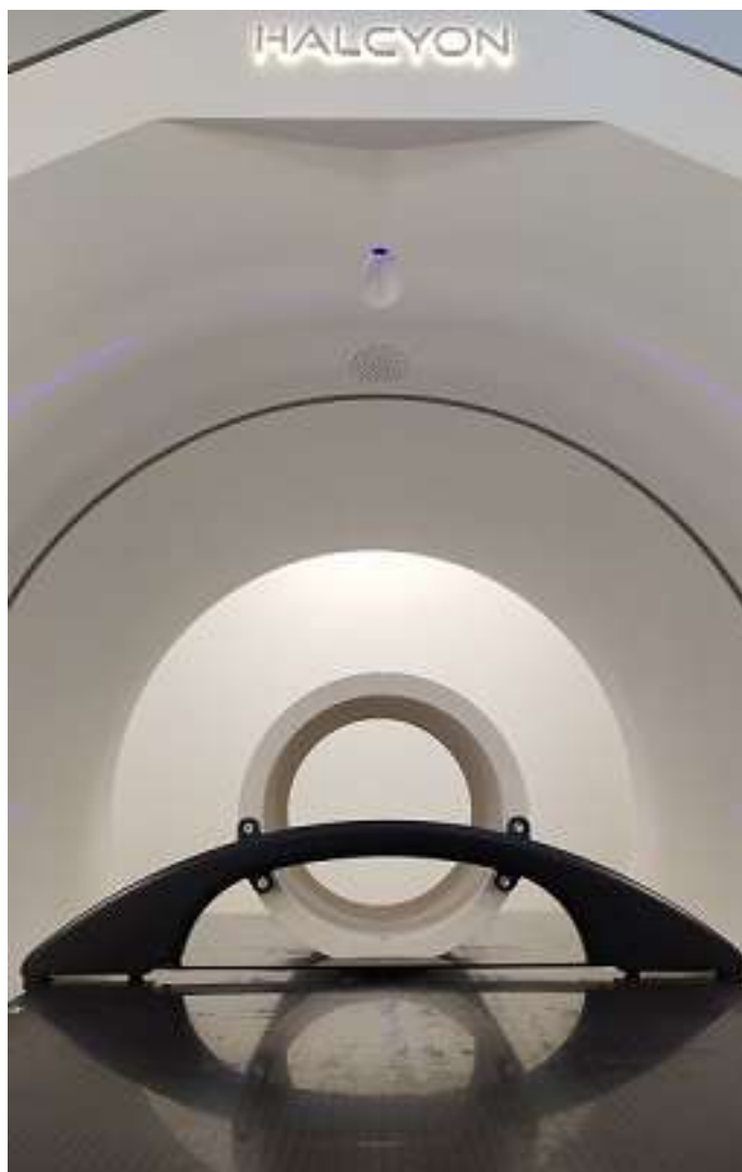
Figure 615: Maniquí del MPC posicionado en la mesa de tratamiento del Halcyon
