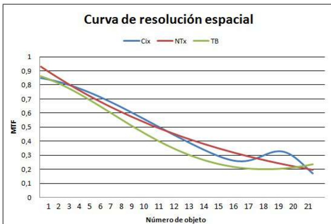
Figure 289: Curva de resolución espacial para las tres máquinas
