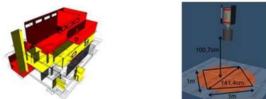
Figure 145: Clasificación de áreas impactadas: clase 1 en rojo y clase 2 en amarillo (a la izquierda) y Geometría del Ge utilizada (a la derecha)
